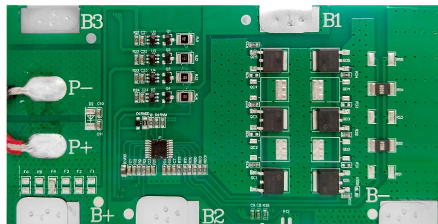
**BMS (Battery Management System)** – это система управления батареями, предназначенная для контроля и балансировки напряжения, тока и температуры на каждой ячейке аккумулятора. Она обеспечивает безопасность работы батареи и предотвращает ее выход из строя в результате перезарядки, переразрядки, короткого замыкания или перегрева.
