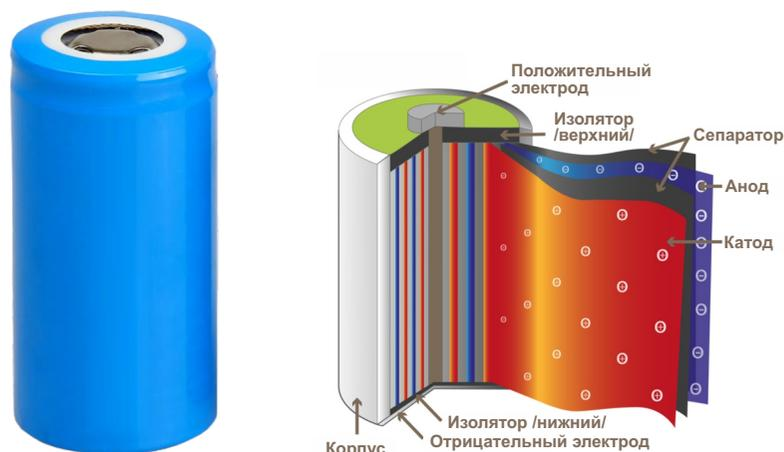
Рис.1. Конструкция – рулонная
