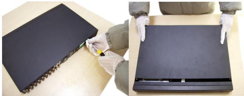
Открутите шурупы и снимите верхнюю крышку устройства
